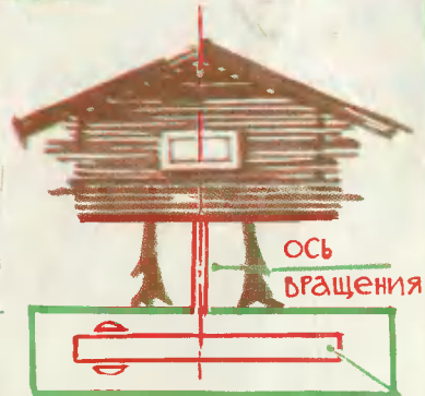
микродвигатель с редуктором, скрытым в основании
